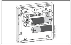
Fig. 17 Replace batteries
