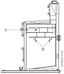
Fig. 78 Baffle positioning
