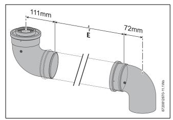
Fig. 7 90° bend offset dimensions
